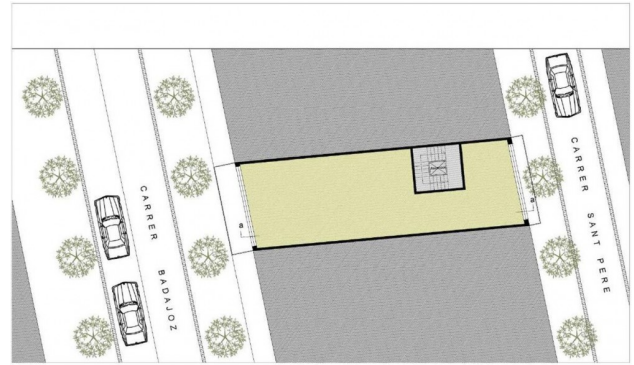
Planta Tipo c/ ST. PERE 16 Vivienda Tipo (6,17 x 16,47) Superficie = 100 m 2 03
